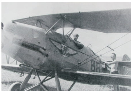
Stroj Arado Ar 66C byl běžný dvousedadlový dvouplošník poháněný motorem Argus As 10. Byl vyráběn od r.1933 v počtu několika tisíc kusů. Na fotografii stroj s označením BB+FE se znakem letecké školy Sch/FAR 71 z Prostějova.
